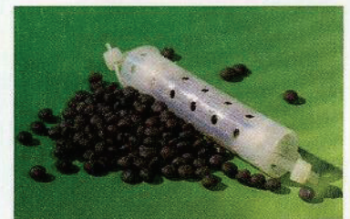
↑ 01 „Bakterienfallen“ weisen den Grad des natürlichen Schadstoffabbaus in belasteten Böden nach.
